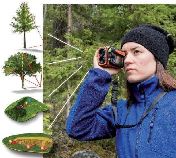
Slika 47 Područja primjene Vertex Laser Geo (Haglof, 2022; Petković, 2023)
