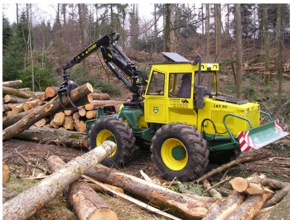
Slika 16. LKT 82 skider s hidrauličnom rukom i vitlom ( https://souzles-nn.ru )
