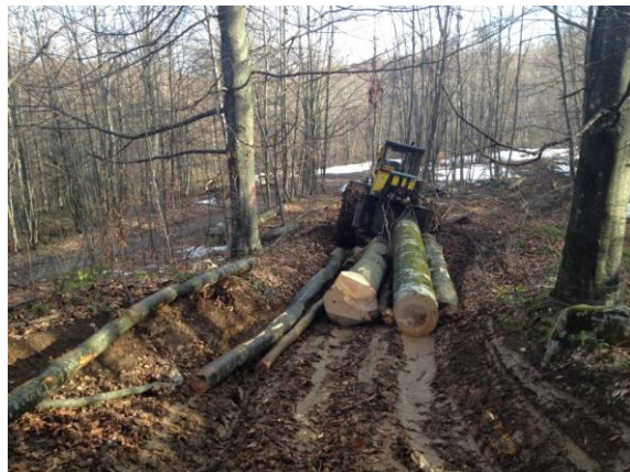
Slika 21. Privlačenje sa LKT81T skiderom (Foto, Marčeta D.)
