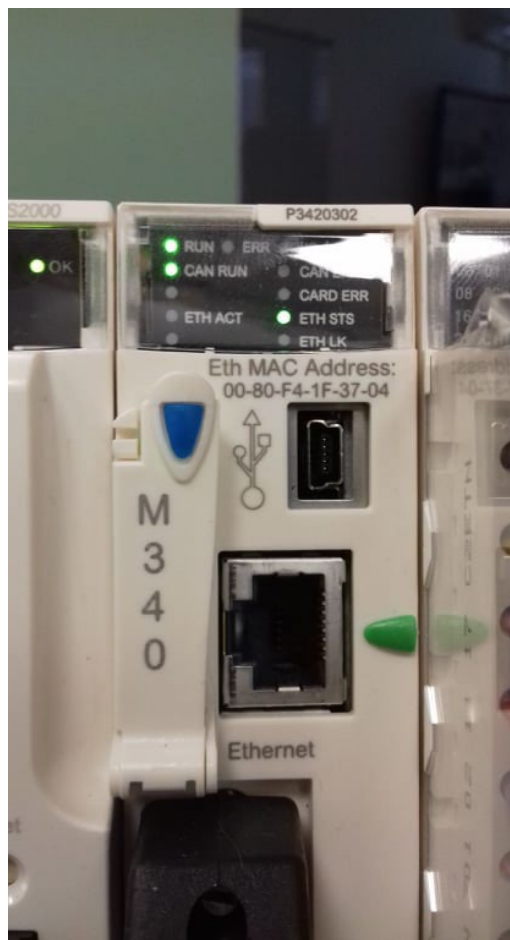
Слика 87 – Комуникациони портови на процесорском модулу ПЛК-а који се могу користити за повезивање са рачунаром
