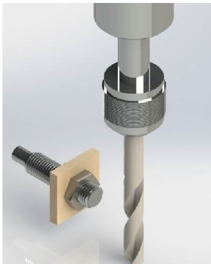
Слика 122 – Илустрација детекције лома бургије на машини
