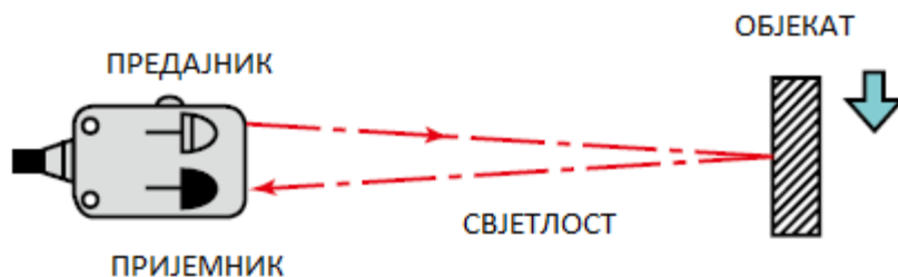
Слика 28 – Принцип рада оптичког детектора присуства
