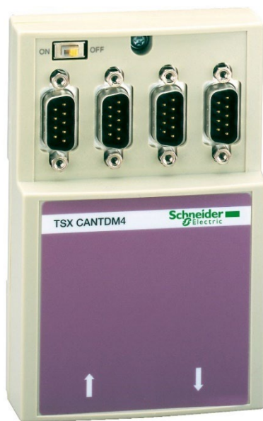
Слика 31 – Чвориште за CANopen комуникацију TSXCANTDM4
