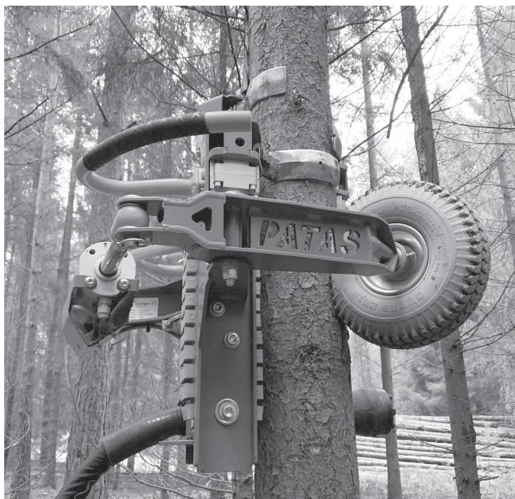
Слика 11-19. Patas систем за орезивање грана (извор: Advaligno GmbH)
