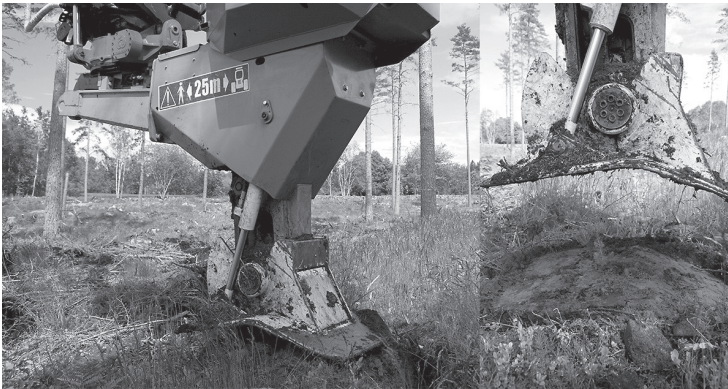
Слика 10-23. Систем рада аутоматизованог система за садњу компаније „Bracke forests” (извор: Bracke forests, 2023)
