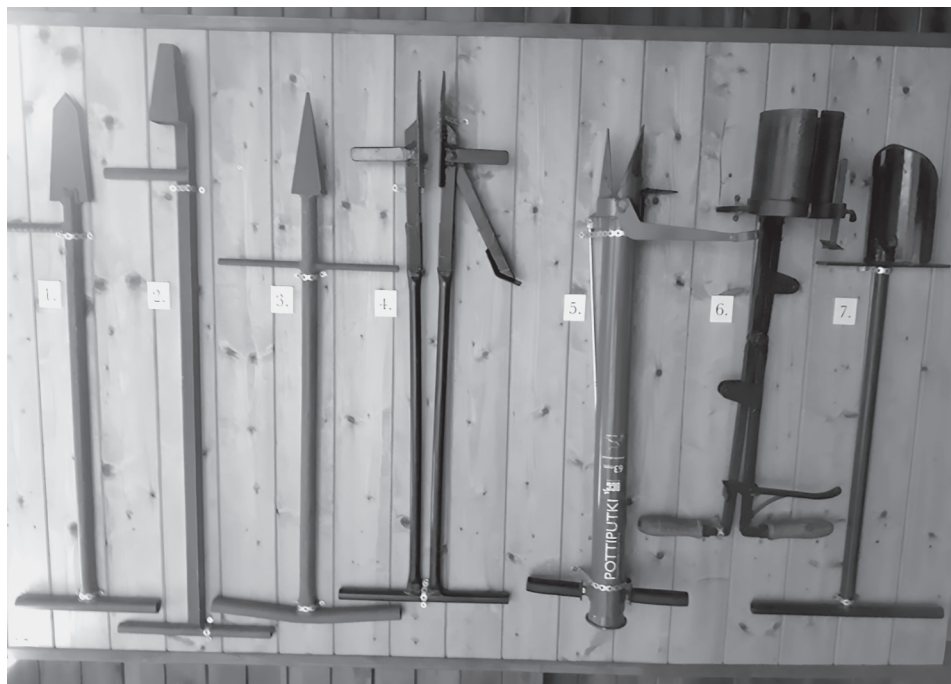
Слика 10-13. Садилнице: 1, 2 и 3 са збијањем земљишта; 4 и 5 са отварањем позиције у земљишту за садњу; 6 и 7 са отварањем специфичних засјека у земљишту прилагођених облику контејнера
