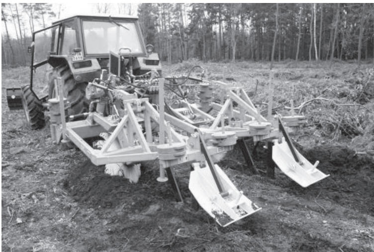
Слика 8-6. Плуг са подривачима и обртним дискovima за формирање гребена (фото: Ośrodek Techniki Leśnej w Jarocinie, 2023)
