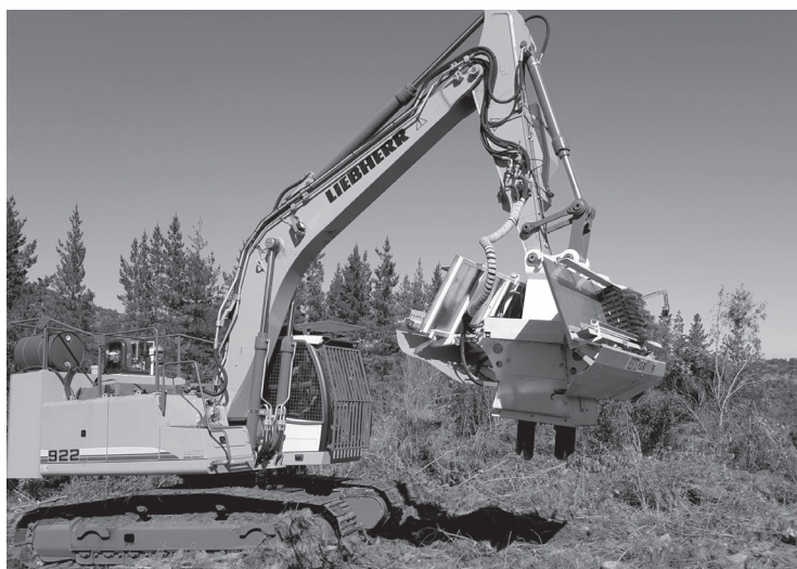
Слика 10-21. Аутоматизовани систем за садњу компаније „Risutec” прикључен на багер (извор: компанија „Risutec”)
