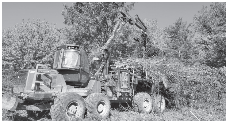
Слика 7-2. Харвестер у функцији извлачења оборених стабала (фото: Матаруга, 2021)
