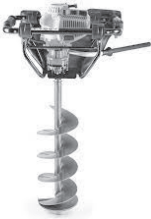
Слика 8-16. Моторно сврдло за отварање јама (фото: „Stihl” компанија, 2023)
