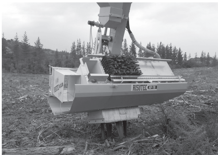
Слика 10-20. Аутоматизовани систем за садњу компаније „Risutec” (извор: компанија „Risutec”)
