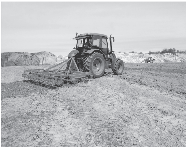
Слика 14-13. Агротехничке мјере у рекултивацији депосола, примјена НПК ђубрива и допунска обрада површинског слоја техногеног земљишта (фото: Малић, 2020)
