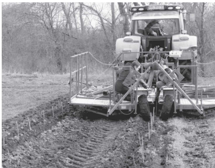
Слика 8-15. Оснивање плантажа прутевима (извор: https:// biophilja.net/ agroforst-bei- biophilja/ )
