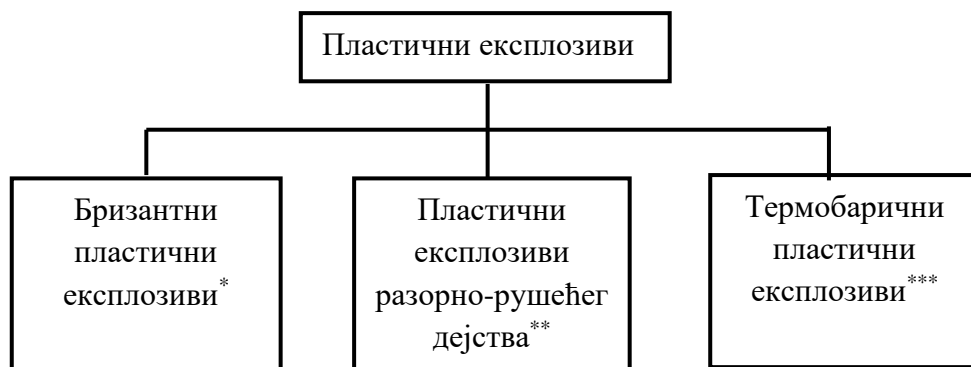
Слика број 42. Подјела пластичних експлозива према енергетском потенцијалу, односно ефекту дејства, *– високи детонациони параметри; **– појачани ефекат фугасног (рушећег) дејства; ***– експлозиви просторног дејства
