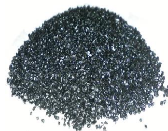
Слика број 2. Црни барут, смјеша сумпор, дрвеног угља и калијум-нитрата
